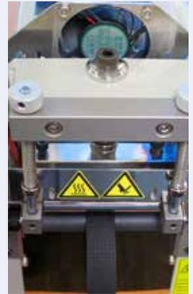
**Zwischen der ersten Idee und der Verwirklichung einer neuen und inzwischen schon voll ausgelasteten Sparte lagen nur wenige Monate: In der Werkstatt des Tannenhofs wird neuerdings mit Ultraschall geschweißt. Mit diesem Verfahren können stabile Verbindungen zwischen Kunststoffen und vielen anderen Materialien geschaffen werden.**
